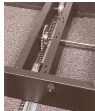
Převod ručního pohonu na kolejnice
